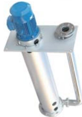
**5.** Für grössere Eintauchtiefen, liefert PACKO Pumpen mit bis zu 1,5 m Wellenlänge. Diese Pumpen sind mit einem zusätzlichen Lager im Pumpengehäuse ausgerüstet.
