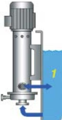
**4.** Ausführung **IMO** in der die Pumpe außerhalb des Fasses montiert wird. Ein Bypass (1) soll versehen werden, die als Überlauf dienen kann. Auf der Foto ist noch ein zusätzlicher Reinigungsanschluss (2) sichtbar.
